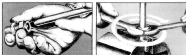
将卡套初步安装到管子或管子的翻边管件上
